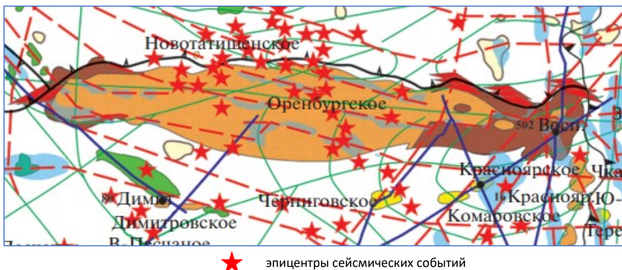
Рис. 6. Схема связи систем нарушений различного простирания в районе ОНГКМ с эпицентрами зафиксированных сейсмических событий
