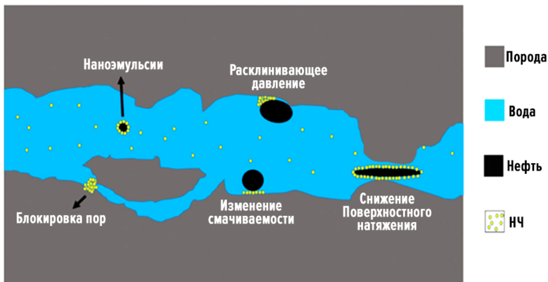
Рис. 1. Схематическое представление влияния наночастиц на механизм вытеснения нефти водой в пористых средах
