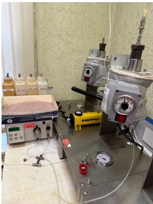
Рис. 2. Внешний вид аппарата для проточной очистки образцов ядра FTCC-100
