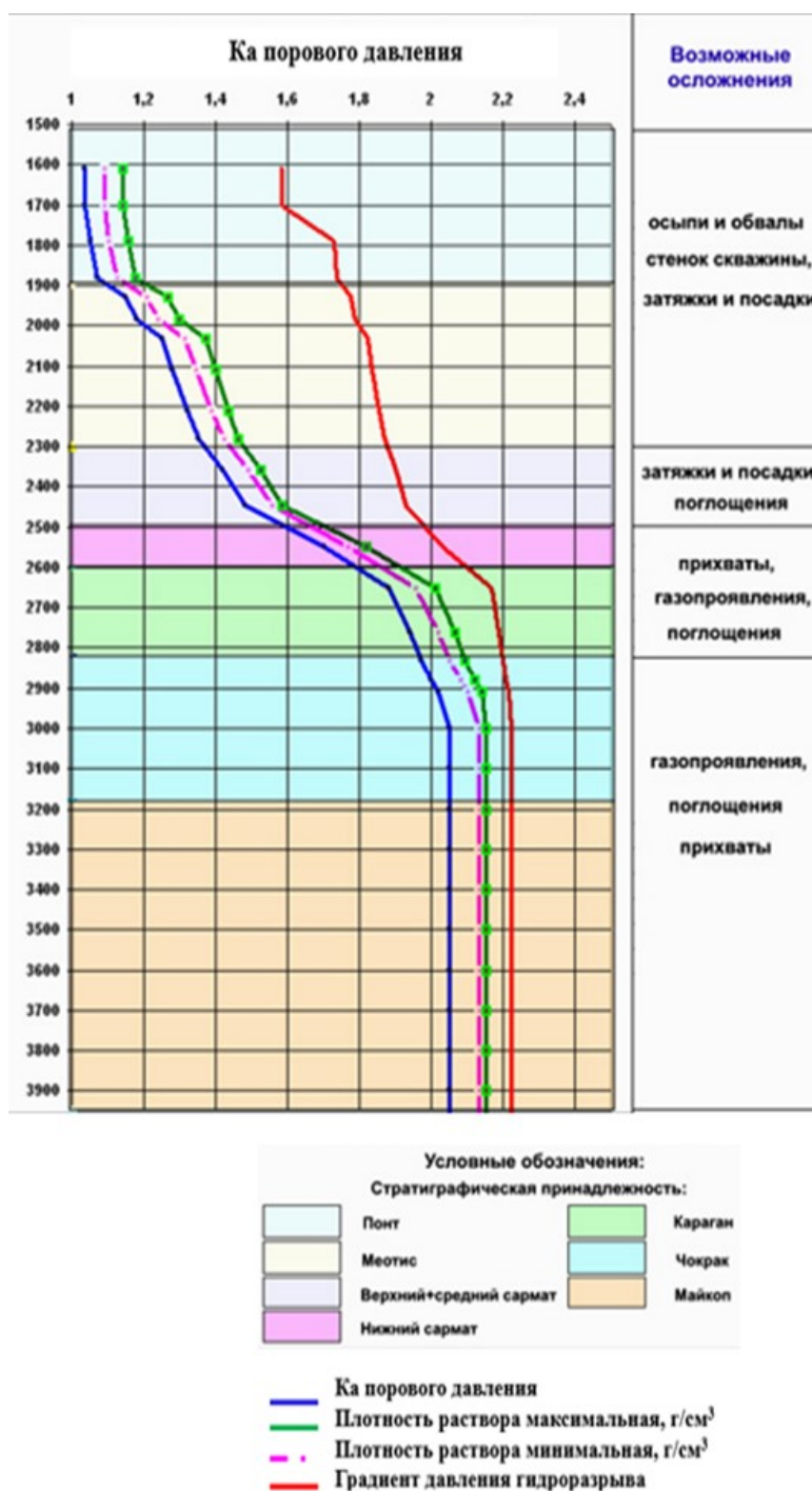
Рис. 4. График соотношения давлений для проекта строительства поисково-оценочной скважины в акватории Азовского моря
