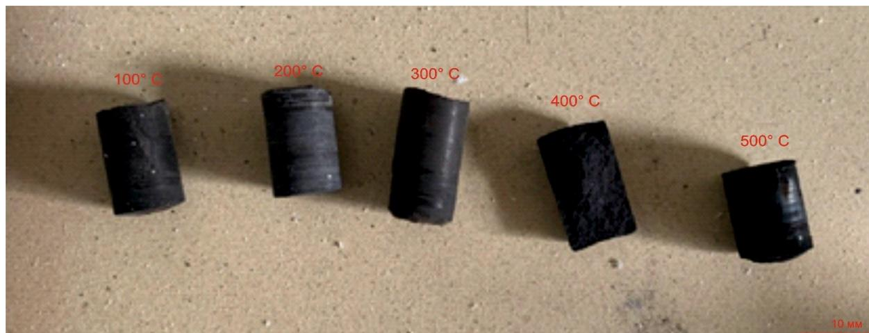
Рис. 3. Экспериментальные образцы после прогрева
