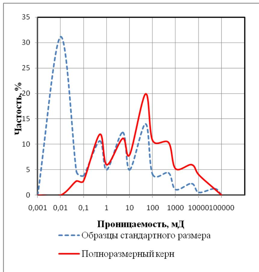
Рис. 2. Распределение проницаемости для образцов стандартного размера и полноразмерного керна
