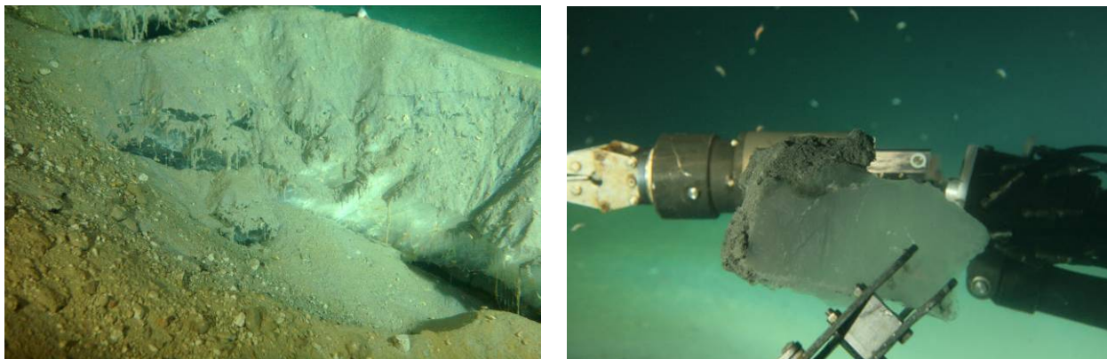
Рис. 1. Обнажение ГГ на дне Байкала (1400 м), полупрозрачный образец ГГ в схвате манипулятора
