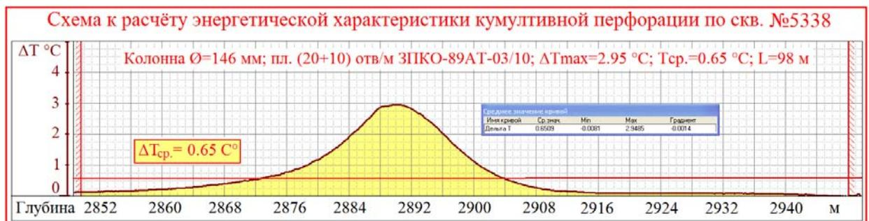
Рис. 9. Графическая обработка термоаномалии в программе «Геофит»
