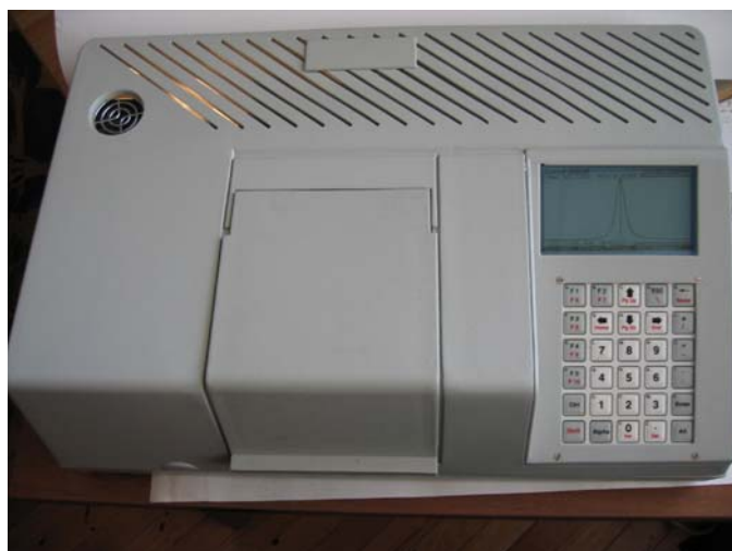
Рис. 4. Инфракрасный анализатор «ИКАР-3»
