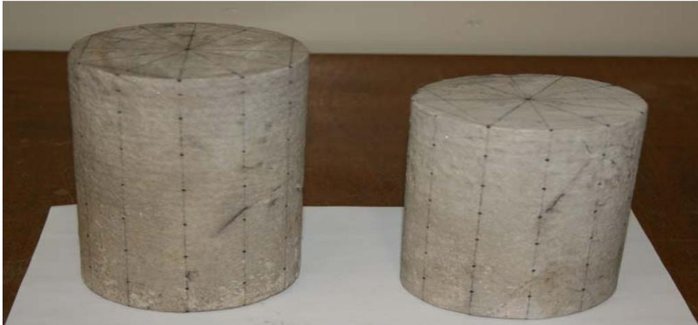
Рис. 2. Размеченные и подготовленные к исследованиям образцы кернов
