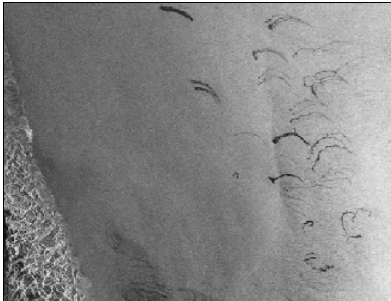
Рис.6. Естественные нефтепроявления в южной части Каспийского моря. Радиолокационное изображение со спутника Envisat, 05.05.2004. (© ESA)
