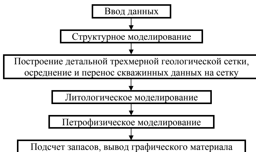
Рис. 4. Блок-схема создания цифровой геологической модели пласта C_{1bb} Богородского месторождения
