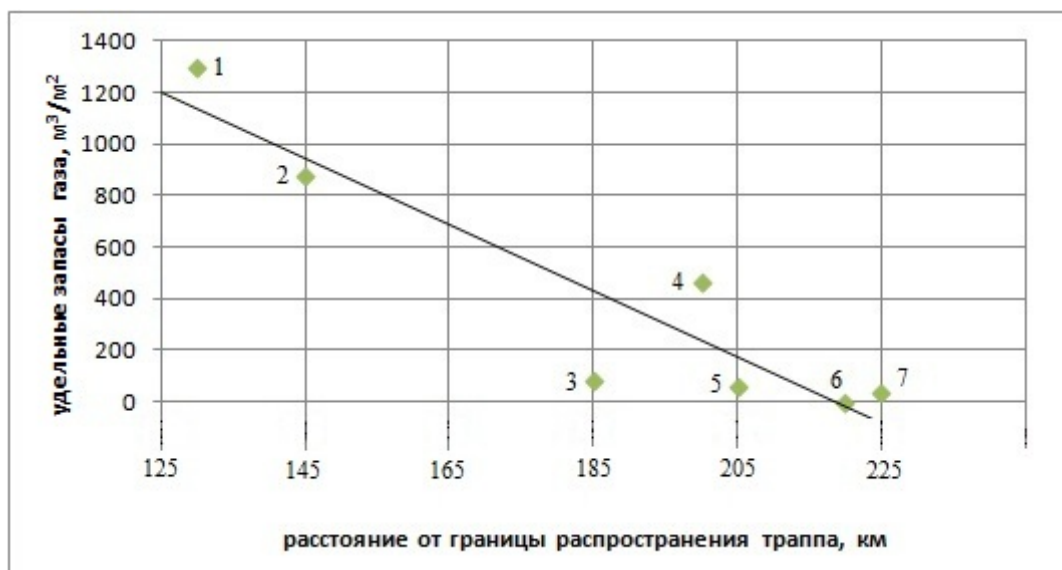
Рис. 3. Зависимость удельных запасов горючего газа от расстояния от северо-западной границы распространения траппа
