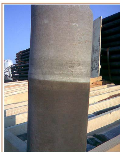
Рис. 9. Керна; верх – известковистый песчаник, низ – песчаник м/з, нефтенасыщенный
