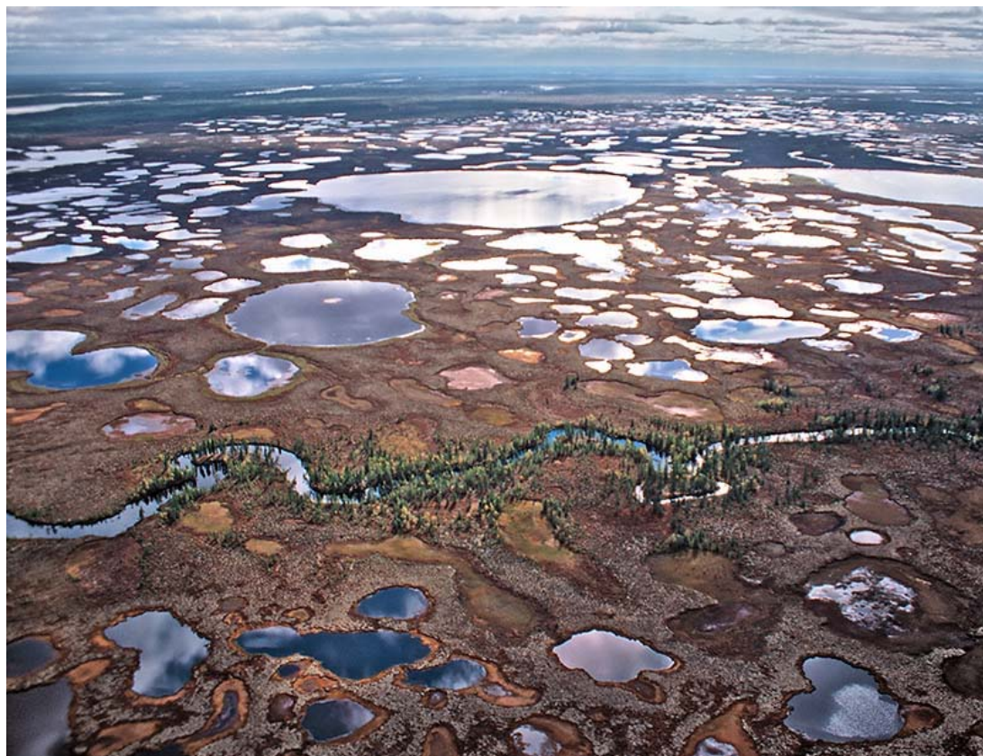
Рис. Б.3. Процессы активизации заболачивания, термокарста, пучения
