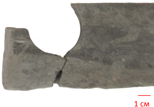
Рис. 1. Пятнистая нефтенасыщенность контролируется биогермной текстурой. Плотные колонии строматопор (1) на фоне микропористого заполнения (2). Верхний девон. Волго-Уральская НГП
