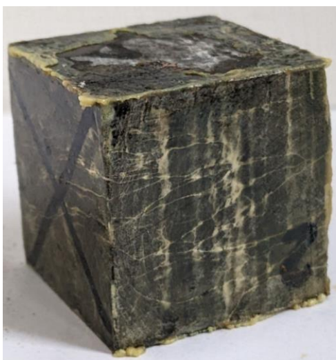
Рис. 4. Фото образца А2 после испытаний на установке ИСТНН
