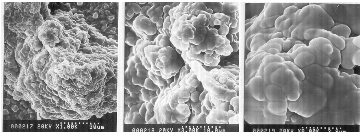
Рис. 3. Набухание образца карбонатной породы (в 5,5 раз) в дизельном топливе. ОНГКМ, известняк, P 1 art. Увеличения в ряду слева направо 1, 3 и 8 тыс. раз соответственно
