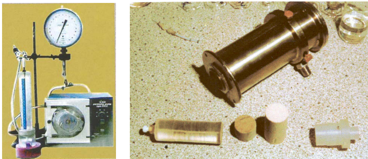
Рис. 8. Скрин-вискозиметр и лабораторная модель пласта
